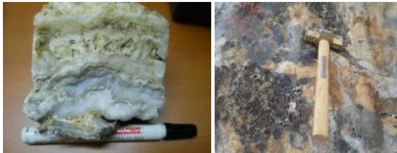
Gambar 155. Kenampakan batuan terubah akibat aktivitas hidrothermal, tipe epitermal dengan ciri-ciri adanya struktur kuarsa berlubang, sarang tawon, laminasi sejajar, kuarsa kristalin, dan breksi hidrothermal.
