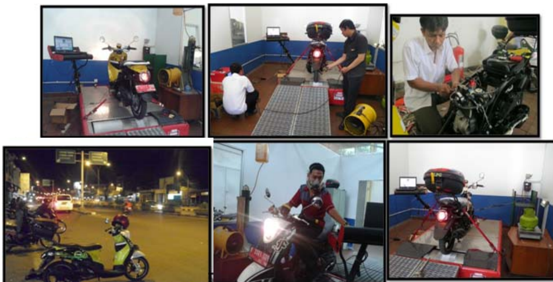
Gambar 31. Setting peralatan konversi, uji chassis dynamometer , dan uji jalan/ road test sepeda motor LPG
