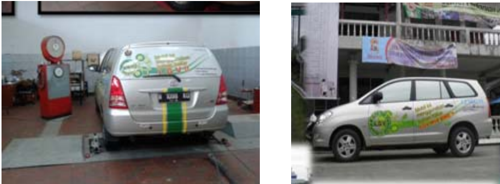
Gambar 32. Pengujian chassis dynamometer dan Uji Jalan kendaraan dengan bahan bakar LGV dan LGV mix DME
