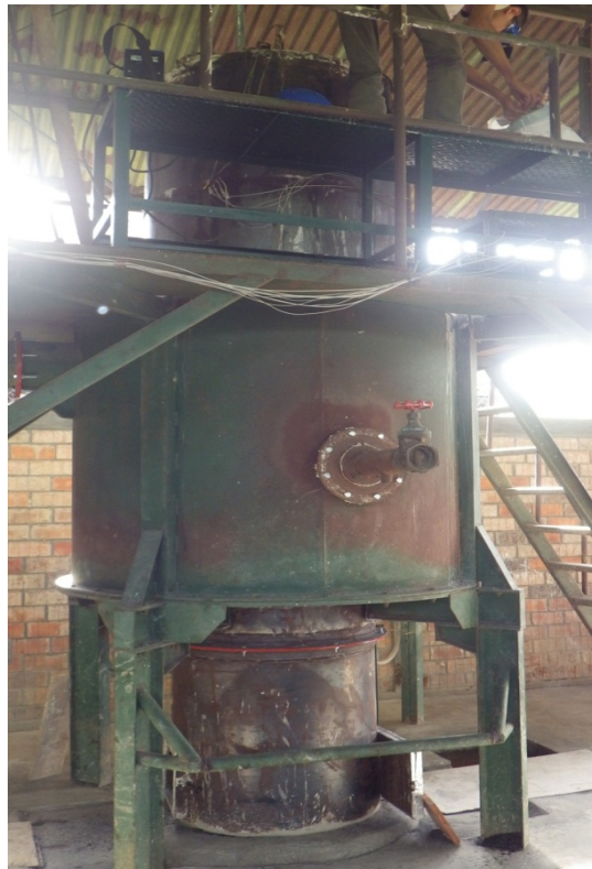
Gambar 36. Reaktor gasifikasi setelah modifikasi
