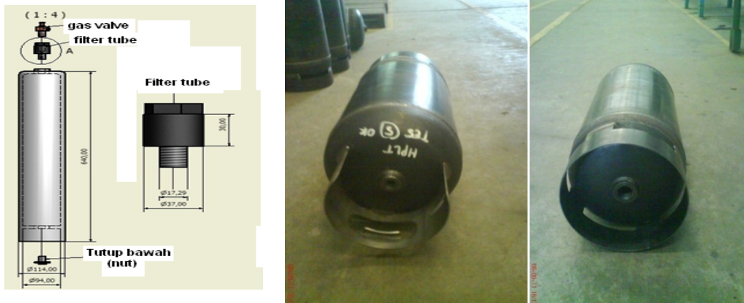
Gambar 32. Bagian-bagian tabung ANG
