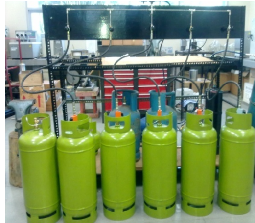
Gambar 35. Proses pengisian Tabung ANG secara paralel
